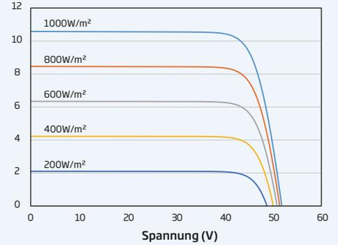
**P-V KURVEN DES PV-MODULS (440 W)**
